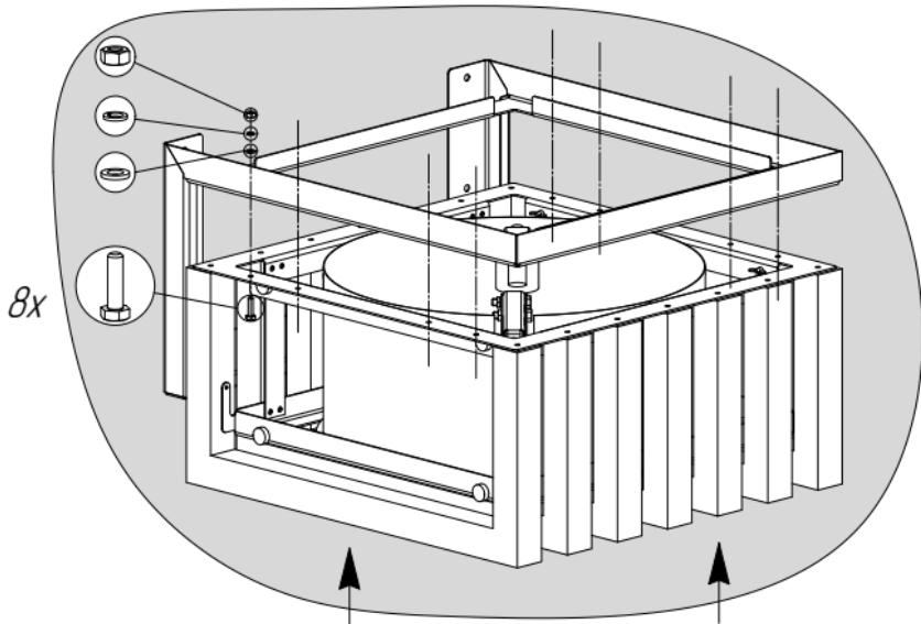
**3.1.2.** Установите обливное устройство на кронштейн (8) и с помощью крепежных элементов (входят в комплект поставки кронштейна) в восьми местах закрепите его.
