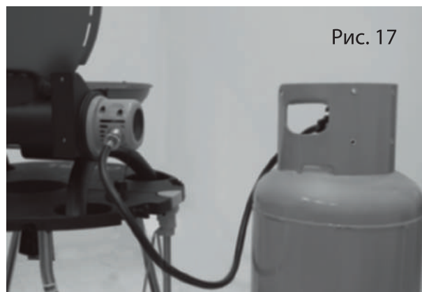
Подключение напольного газового баллона
