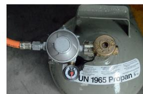
Откройте вентиль газового балона. После чего сразу проверьте мыльным раствором герметичность всех соединений. Модель гриля In&Out оснащена манометром встроенным в редуктор. Если после открытия вентиля, через 10 сек его закрыть, то можно проверить герметичность наблюдая за давлением газа в шланге и гриле. Если давление не падает после открытия и закрытия вентиля, то система подачи газа в гриль герметична. Если давление падает, то нужно еще раз проверить все соединения и шланг.
