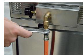
Прикрутите газовый шланг к газовому редуктору. Модель гриля In&Out оснащена блокировкой подачи газа в случае разрыва шланга. Этот элемент системы безопасности должен быть прикручен между шлангом и редуктором. Стрелка на корпусе данного элемента показывает направление движения газа, от балона к грилю. Редуктор прикрутите к газовому балону.
