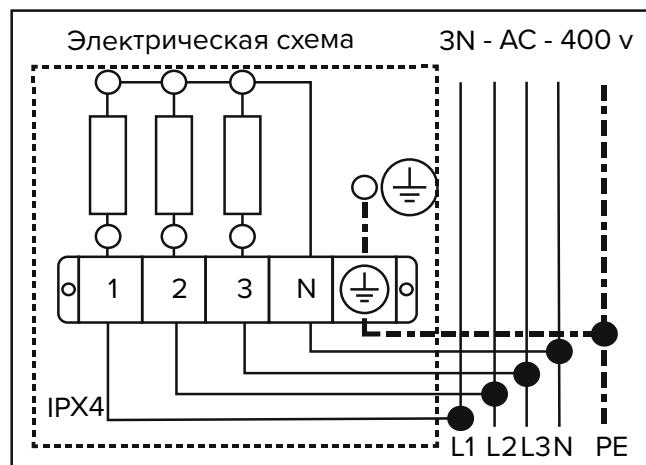
Перед подключением электрокаменки проверьте проводку одного нагревательного элемента и клеммы подключения на прочность. При необходимости затяните винты. Электропроводка для печи и все электрические соединения должны быть сделаны с помощью кабелей, стойких к температуре не ниже 170 °C. Тип кабеля: РКГМ, ПВКВ, ПРКС. Сечение согласно мощности. Смотрите таблицу на странице 9.
