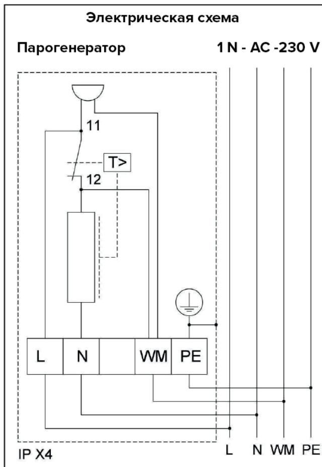
Внимание! Зажим WM можно подключать только к пультам управления с сигнализацией отсутствия воды (230 В). Сигнал WM представляет собой цепь размыкания. Эта настройка должна быть передана пульту управления. Опционально возможно подключение без WM кабеля. Если соединение WM не установлено, только пульт управления не получит сигнала. Защита от сухого нагрева парогенератора и предупреждающий зуммер останутся работать.
