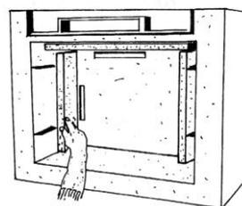
Снять защитную пластину, которая защищает выход дымового канала от перегрева.
