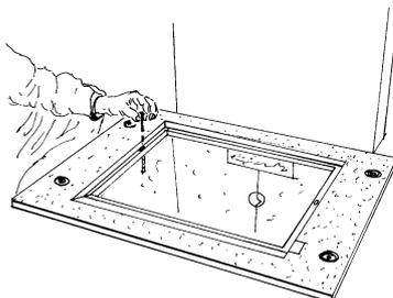
Вынуть все боковые шамотные камни из топки. Вынуть U-образный профиль, затем шамотные камни задней стенки
