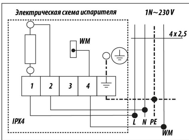
Подключение испарителя печи для сауны соответствует приведенной рядом схеме:
