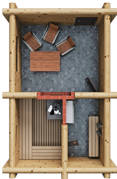
Рис. 10 Пример установки печи в кирпичном кожухе с функцией обогрева комнаты отдыха и моечного отделения
