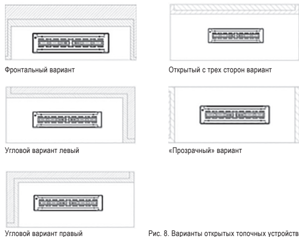
Рис. 8. Варианты открытых топочных устройств
